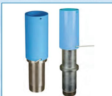
Der Pumpenübergang wird aus rostfreiem Stahl hergestellt und hat auf der einen Seite ein Gewinde und auf der anderen das „Jain Thread Loc Plus“ Kupplungsstück. The pump connector is fabricated of stainless steel having one end threaded to match the socket threads of the pump and the other end to match with the „Jain Thread Loc Plus“ coupler.
