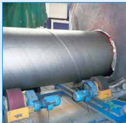
EDELSTAHLFILTERROHR mit angeformter Steckmuffenverbindung
